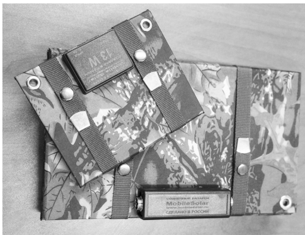
Так выглядят раскладные походные солнечные батареи в сложенном виде.
