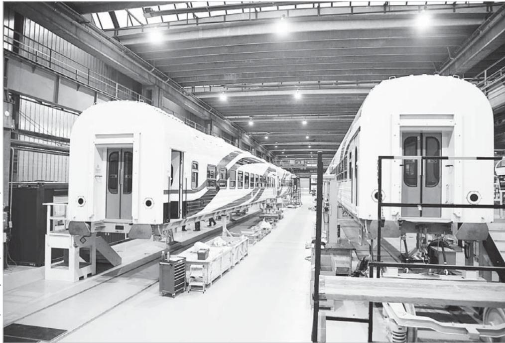
Вагоны модели 61-4514 производства ТВЗ, которые поставляются в Египет, оснащены принудительной вентиляцией и рассчитаны на 88 посадочных мест
