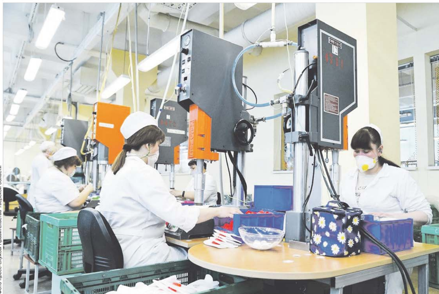
Линия по сборке респираторов на Кимрской фабрике им. Горького
