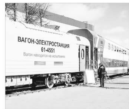
Новое оборудование может работать при температурах от – 50 до + 45 градусов при относительной влажности до 90%
