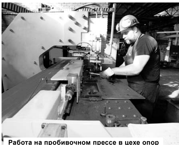
Работа на пробивочном прессе в цехе опор
